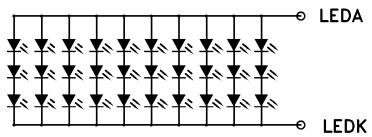
VF=9.6V(Typ), IF=200mA(Fix) 300nits(Min), 350nits(Typ)
