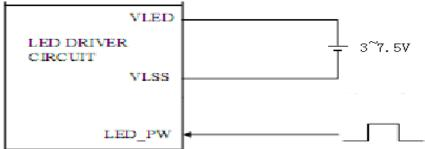
NOTE (1): ADJUST THE PWM SIGNAL IN ORDER TO CONTROL LED BACKLIGHTS BRIGHTNESS. THE HIGHER THE DUTY CYCLE, THE HIGHER THE BRIGHTNESS LUMIN ANCE
