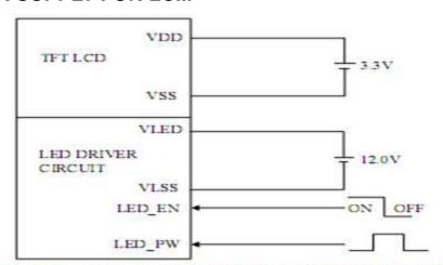
NOTE (1): ADJUST THE PWM SIGNAL IN ORDER TO CONTROL LED BACKLIGHTS
