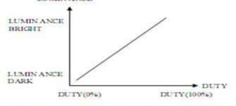
NOTE (2): PWM SIGNAL=0~3.3V · OPERATION FREQUENCY: 100-20000HZ
