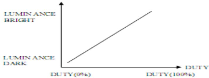
NOTE ( 2 ) : PWM SIGNAL=0~3.3V · OPERATION FREQUENCY : 20±5KHz
