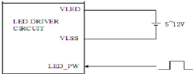
NOTE ( 1 ) : ADJUST THE PWM SIGNAL IN ORDER TO CONTROL LED BACKLIGHTS BRIGHTNESS. THE HIGHER THE DUTY CYCLE, THE HIGHER THE BRIGHTNESS LUMINANCE
