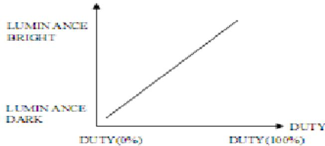
NOTE ( 2 ) : PWM SIGNAL=0~3.3V • OPERATION FREQUENCY : 100+/-5 KHz
